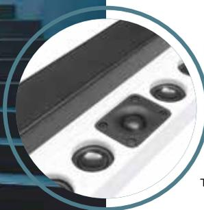
В колонных громкоговорителях Ai41 и Ai81 ВЧ-элемент устанавливается по центру между группами среднечастотных динамиков. Преимущества акустических характеристик этой симметричной конструкции хорошо зарекомендовали себя. В то же время эти акустические системы выигрывают и от использования принципов теории линейных массивов.
